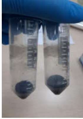
Şekil.5. Karbon numunesinin HCl ile yıkanması.
