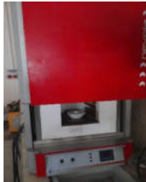
Şekil.4. Kül fırınında 700 °C’de piroliz işlemi.
